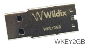
La clé USB Wildix est un lecteur flash qui peut résister à des températures allant jusqu'à 85°C et permet jusqu'à 100.000 cycles d'écriture, supportée par la technologie NAND. L'enregistrement de toutes les données d'exploitation par la clé USB permet d'assurer un remplacement rapide du PBX.
